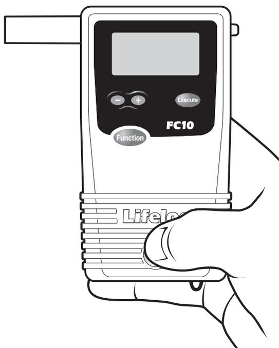
Mantenga presionado el botón de **Encendido** en la parte inferior del frente del aparato hasta que emita un sonido. El FC20BT realiza una verificación de diagnóstico interno automáticamente.
