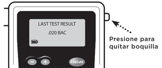
Presione el botón **Función** hasta que aparezca el ícono de la impresora. Los resultados de la última prueba se mostrarán junto con el número de la prueba en el extremo inferior izquierdo del visor.
