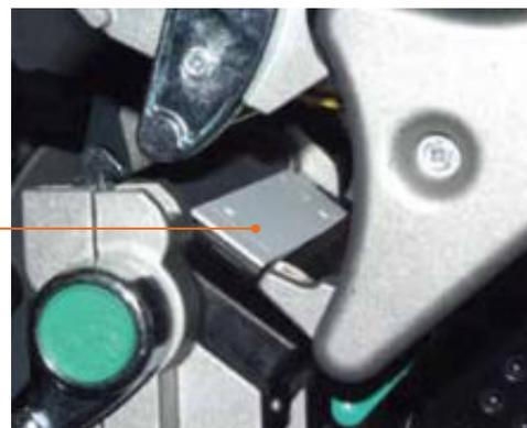
El diseño RFID integrado estratégicamente aumenta la precisión de codificación reduciendo las interferencias electromecánicas con la impresora. Esto asegura la máxima precisión al imprimir etiquetas RFID.
